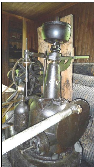
Svinghjul og aksling til venstre og regulator til høgre. Frå saumfaringsrapport Oppland Fylkeskommune, 2012.
